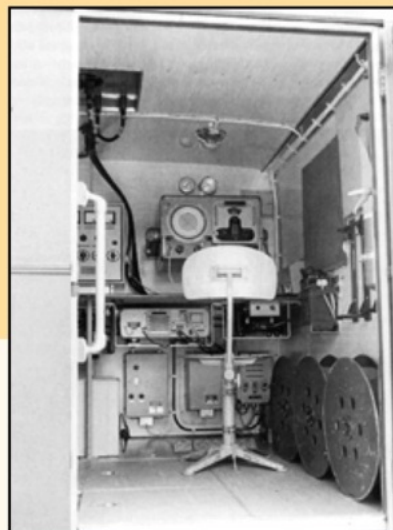
◀ DAF YA 126 Radiopeilwagen (KL/MRD 3554), bedoeld om de locatie van vijandelijke radiozenders op te sporen
