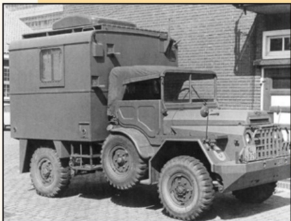
◀ DAF YA 126 Radiopeilwagen (KL/MRD 3554), bedoeld om de locatie van vijandelijke radiozenders op te sporen
